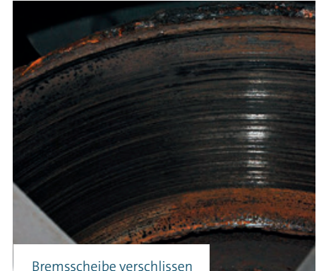
Brems Scheibe verschlissen
